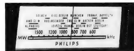
Bild 3. Bedruckte Leuchtplatte als Radioskala
