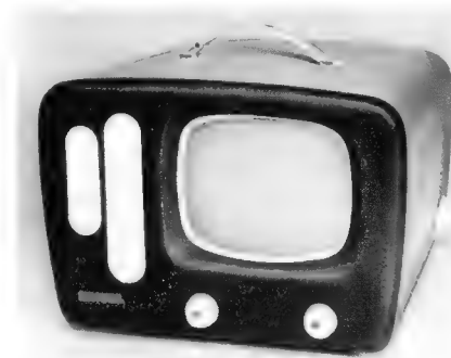
Bild 1. Tragbarer Fernsehempfänger Modell Prinz von Kaiser-Radio, Bildgröße 14,5 \times 18 cm
